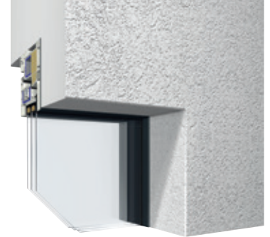
Laibungsvariante mit verdeckt liegenden Fensterrahmen
